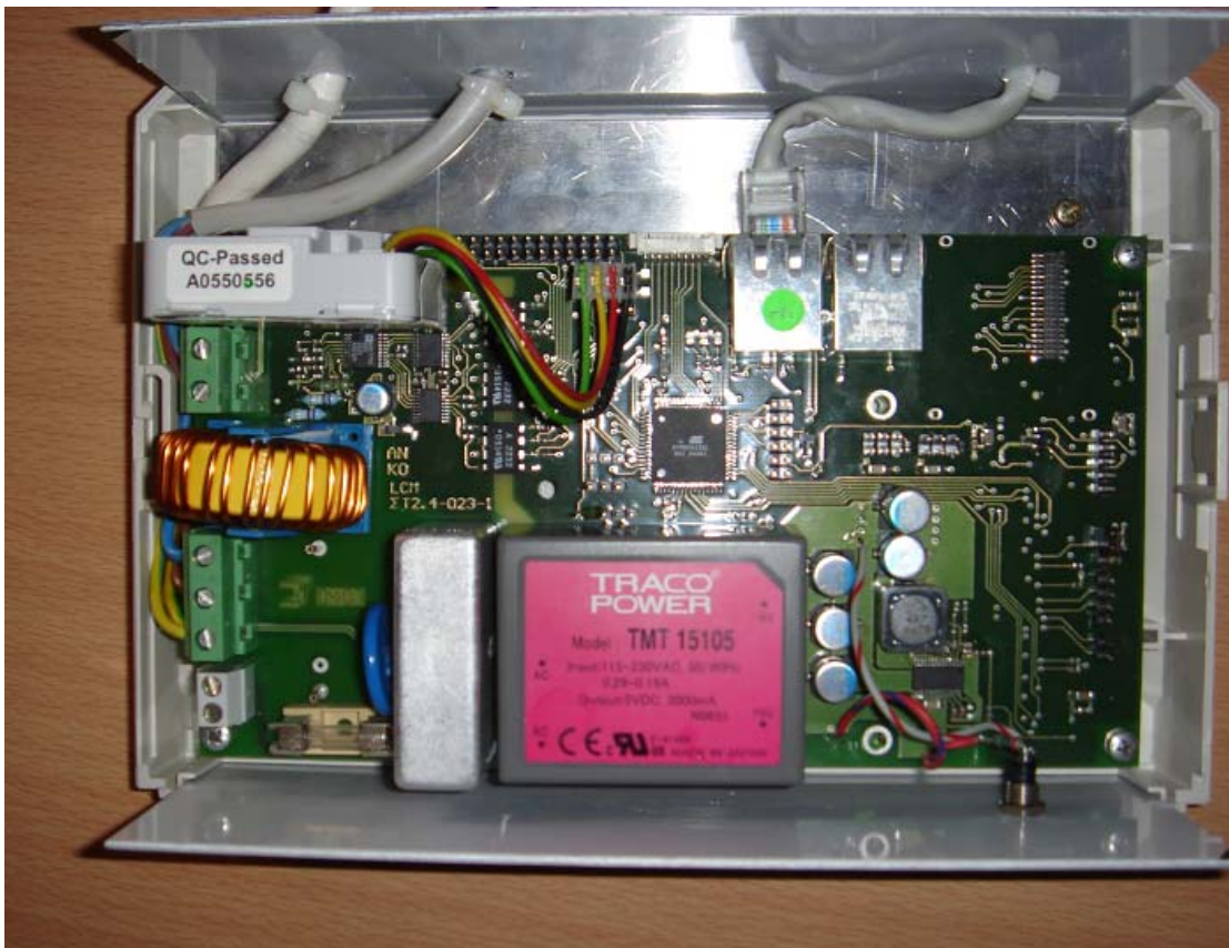
Σχήμα 3.6: Η ηλεκτρονική πλακέτα του ευφυούς ελεγκτή φορτίου. Από την κάτω μεριά της πλακέτας βρίσκεται ενσωματωμένος ο επεξεργαστής.
