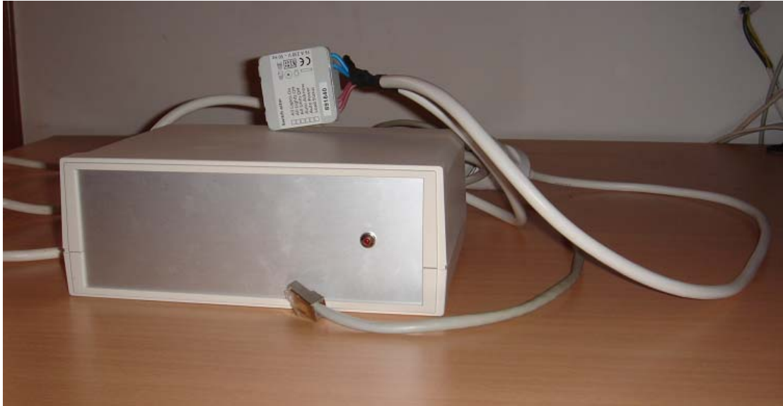
Σχήμα 3.5: Ο ILC που χρησιμοποιήθηκε για τις εργαστηριακές δοκιμές. Διακρίνεται η κόκκινη ενδεικτική λυχνία καλής λειτουργίας, ο PLC διακόπτης καθώς και το καλώδιο δικτύου για σύνδεση με υπολογιστή
