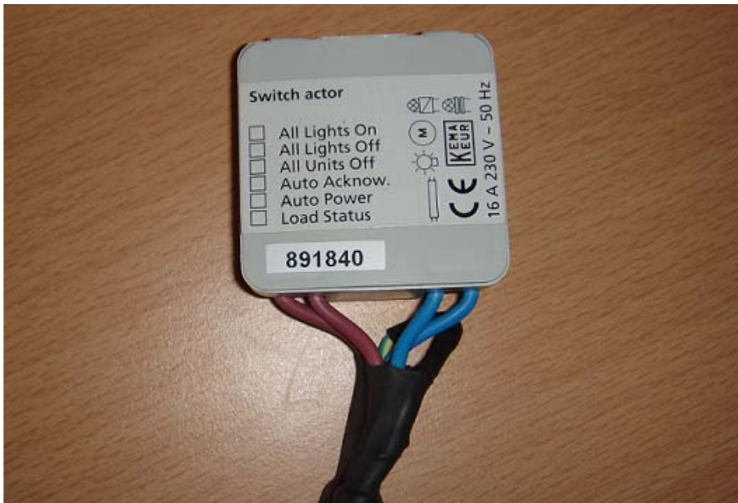
Σχήμα 3.4: Ο διακόπτης PLC A10 (φωτογραφία)
